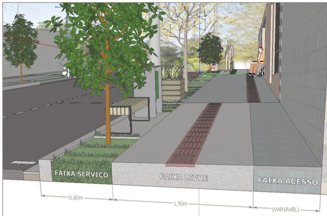
Figura 29 – Seção de calçada no modelo proposto
